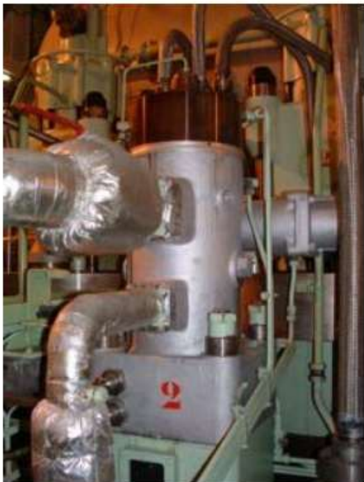
Slika 8. Pumpa goriva i injektori (Vlačić, 2006)
