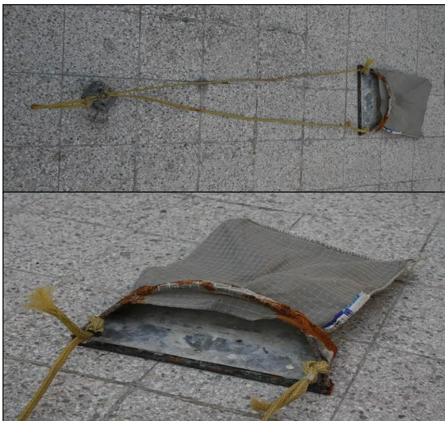
Slika 8. Dredža za sediment (uteg i uže, željezna konstrukcija i mreža "vrećica" za prodaju školjkaša).
