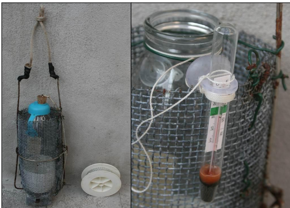
Slika 7. Termometar (sastavljen od košare s olovom, boce i akvarijskog termometra).
