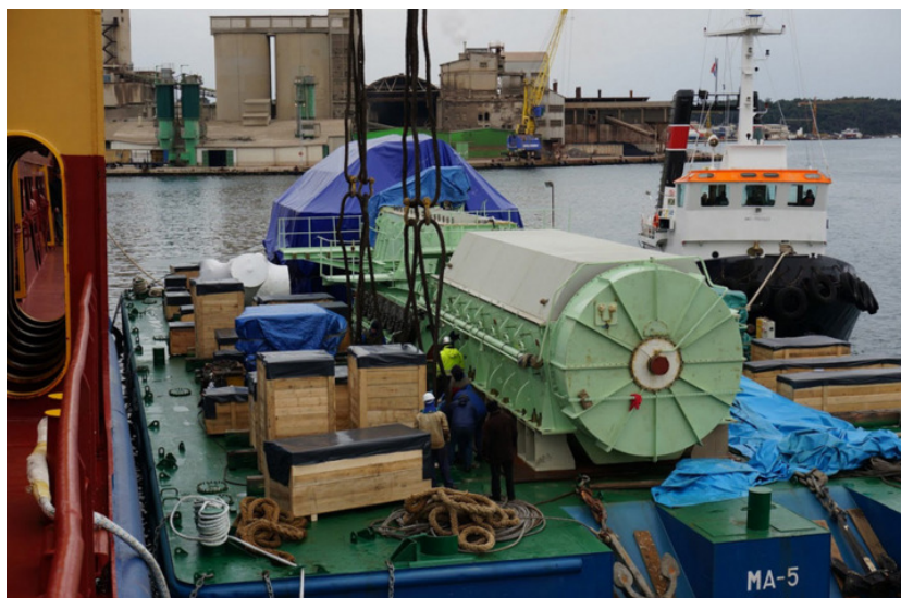
Slika br. 5 Glavni motor Gradnje 722 u dijelovima pred tegalj u Rijeku
