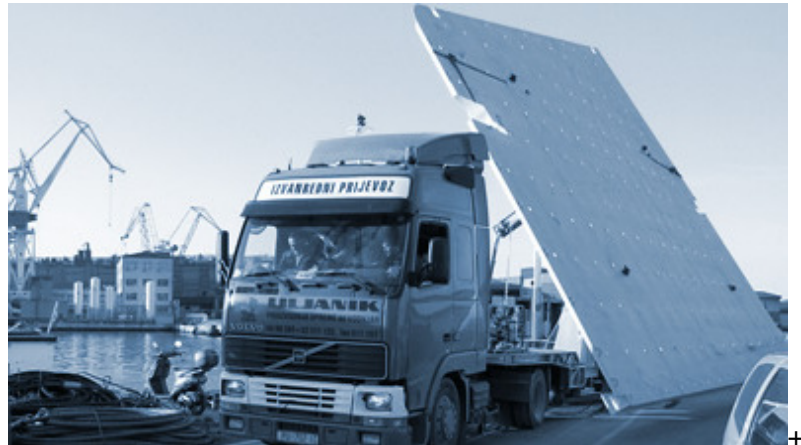
Slika br. 6 Podizna palubica na prekrcaju na baržu
