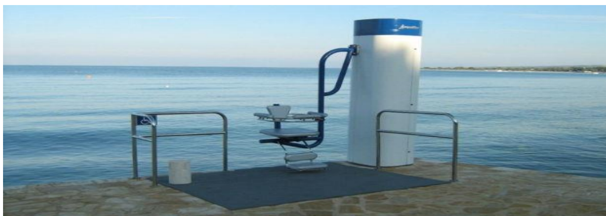
Slika 5. Aqualifter za ulazak osoba s invaliditetom u more
