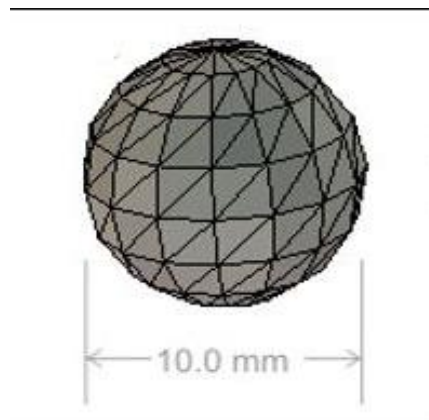
Slika 4. Model mreže optimalne gustoće (SolidSolutions, 2015).
