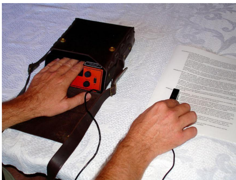
Slika 8. Optacon. Izvor: https://en.wikipedia.org/wiki/Optacon
