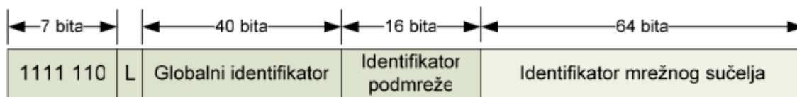
Slika 11: Struktura jedinstvene lokalne IPv6 jednodredišne adrese
