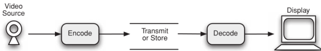
Slika 3. Koder i dekodek
