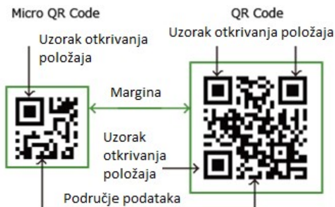
Slika 9. Usporedba Micro QR koda i standardnog QR koda 18
