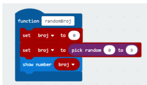
Slika 49. Određivanje blokova naredbi funkcije Random broj
