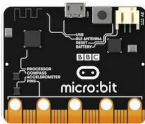
Slika 3. Mikrokontroler: 32-bit ARM Cortex M0+
