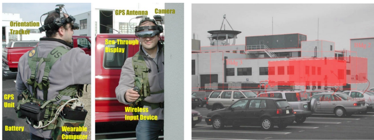
Slika 16. Elementi i prikaz BARS sustava
