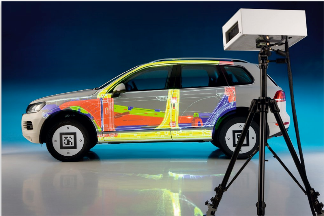
Slika 7. Primjer projekcijske proširene stvarnosti na VW automobilu (Izvor: Patrascu, 2010.)
