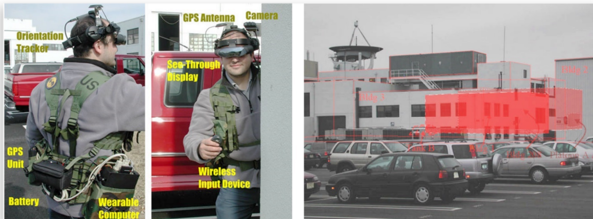
Slika 11. Elementi i prikaz BARS sustava
