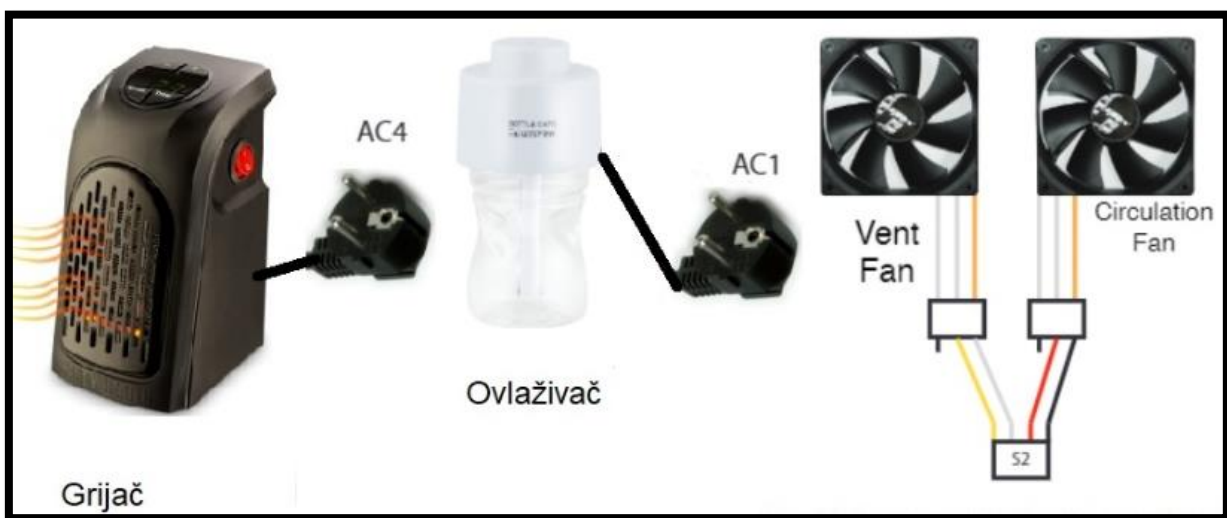
Slika 36. Shematski prikaz modula za izmjenjivanje zraka
