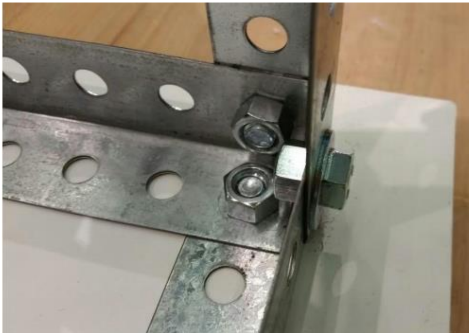
Slika 18. Učvršćena sjecišta kuteva glavnog okvira
