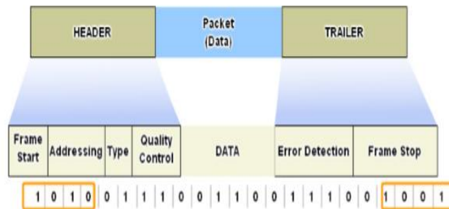
Slika 8. Opći oblik frame-a odnosno okvira(M.Korač;D.Car:Uvod u računalne mreže:2014:32)
