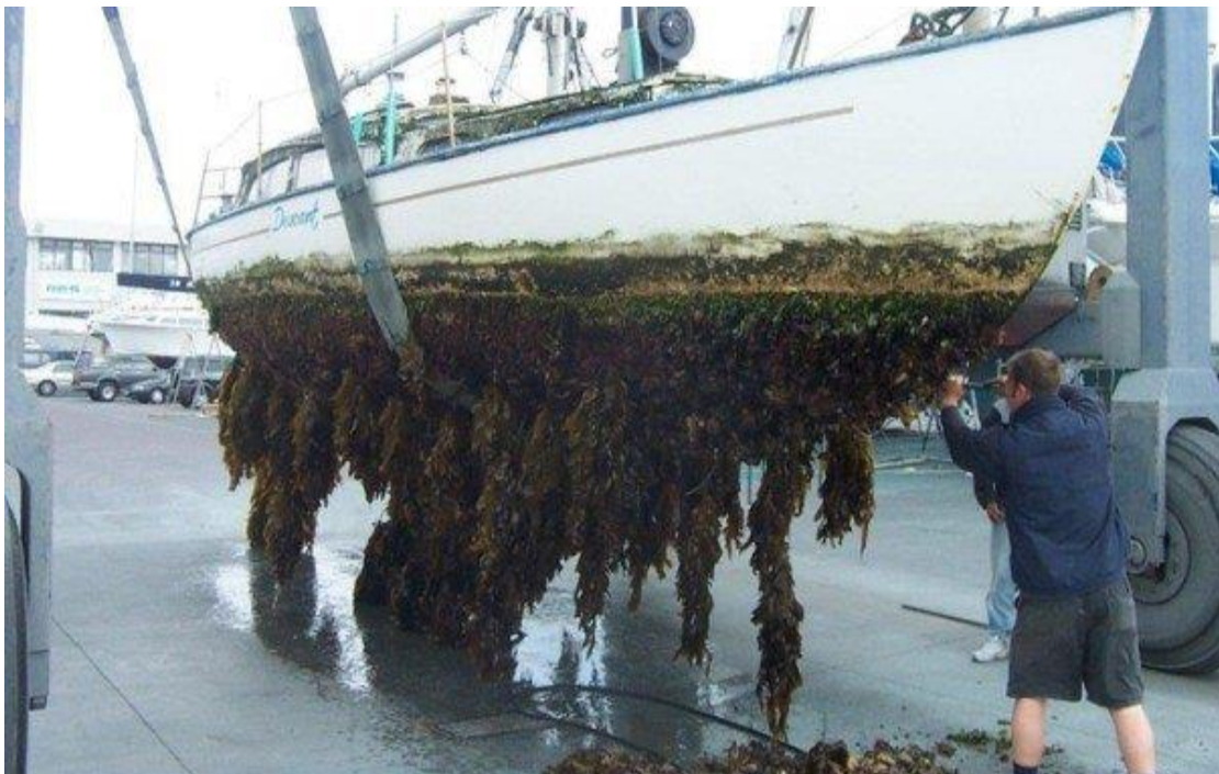
Slika 1. Obraštaj na brodu (izvor: https://smallboater.com/biofouling-guide/ )
