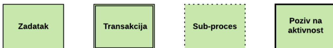
Slika 9. Zadatak (engl. Task ), transakcija (engl. Transaction ), sub-proces (engl. Event Sub-Process ), poziv na aktivnost (engl. Call Activity )
