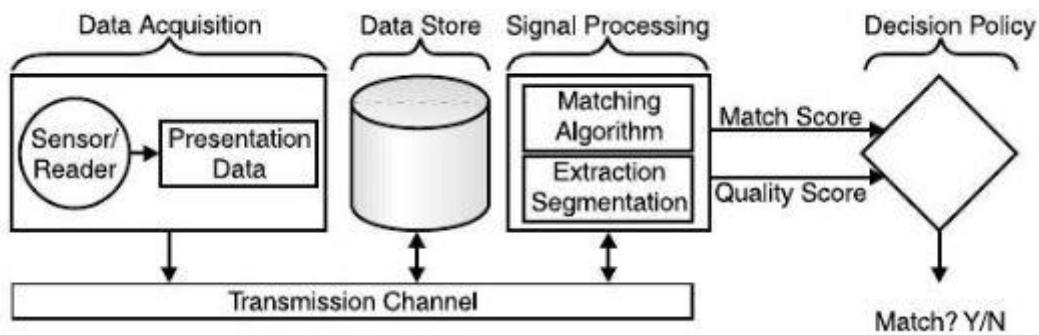
*Slika 8.1.: Dijagram komponenata i toka biometrijskog sustava* <sup>12</sup>
