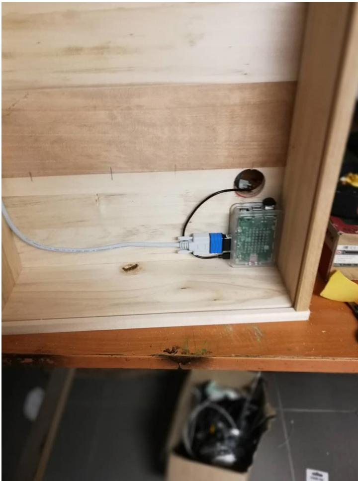
Slika 15: pričvršćen raspberry pi na konstrukciju
