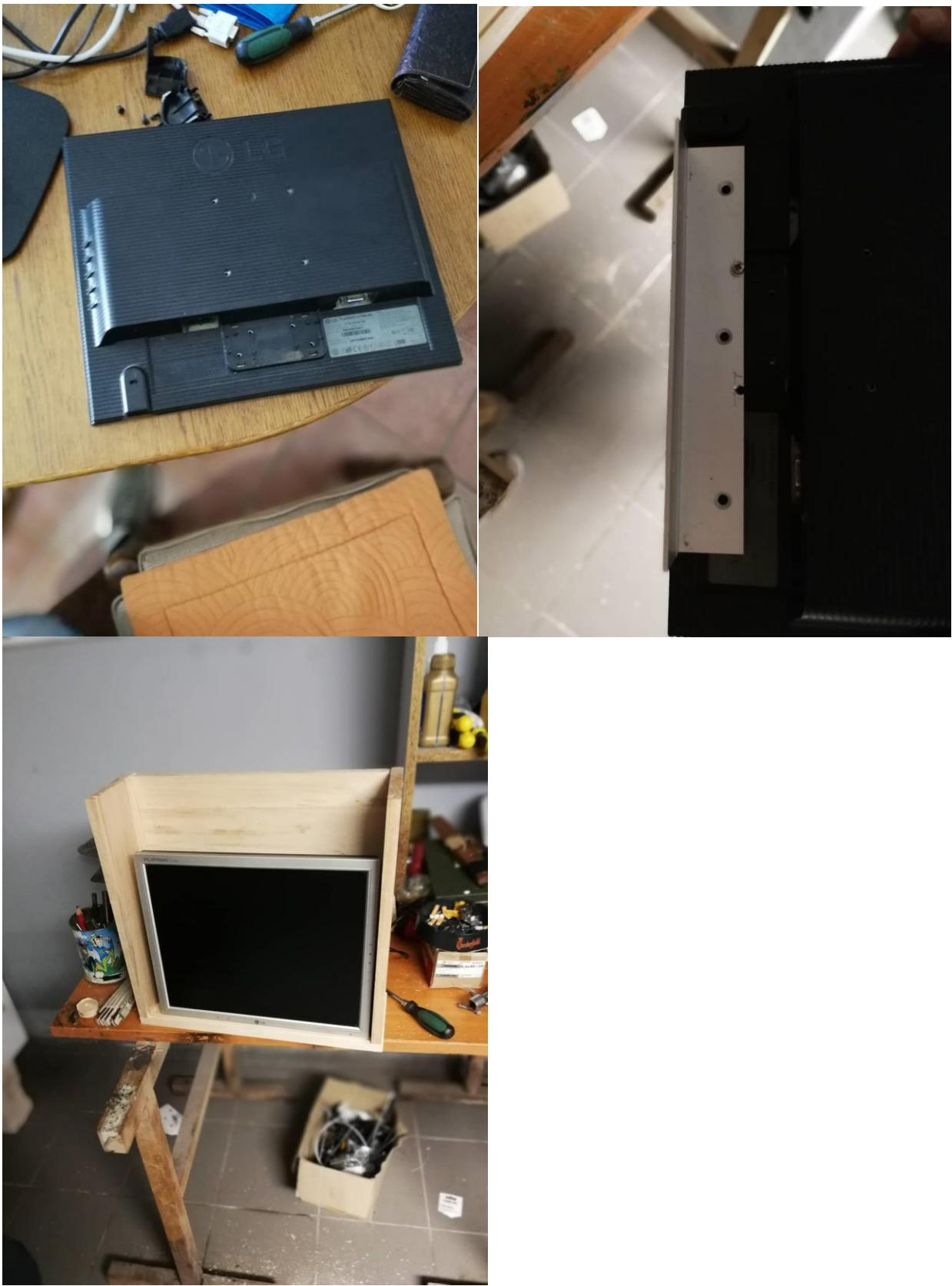
Slika 16,17 i 18: odvajanje postolja monitora te prčvršćivanje na konstrukciju
