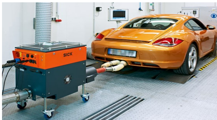
Slika 7. Automobil prikopčan na SICKov ultrazvučni plinski mjerni uređaj Flowsic150 Carflow
