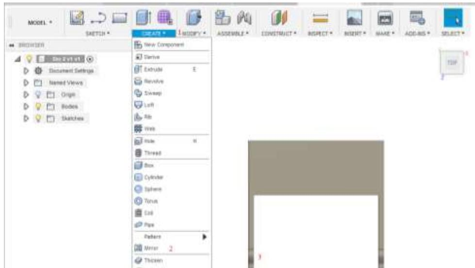
**Slika 47. Kreiranje montažnog dijela na osnovnom elementu**
