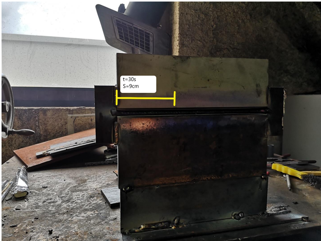
Slika 13 Mjerenje brzine zavarivanja
