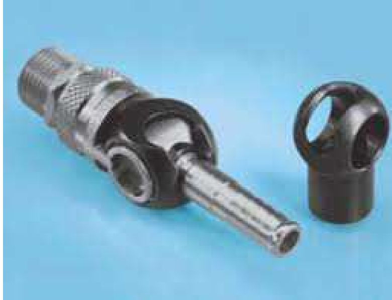
Slika 14. Spojnice nakon nitrokarburiranja TENIFER postupkom [10]
