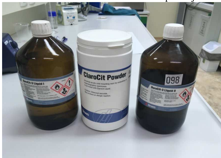
Slika 16. Polimerna masa za zalijevanje uzoraka
