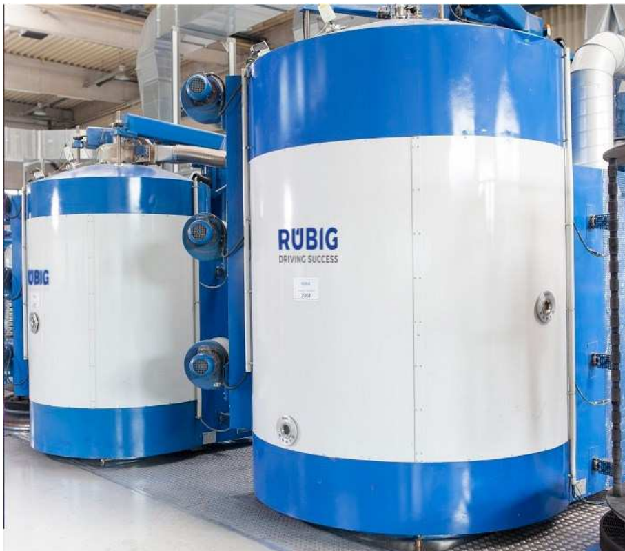
Slika 8. Vakuumska komora za postupak PLASOX [14]
