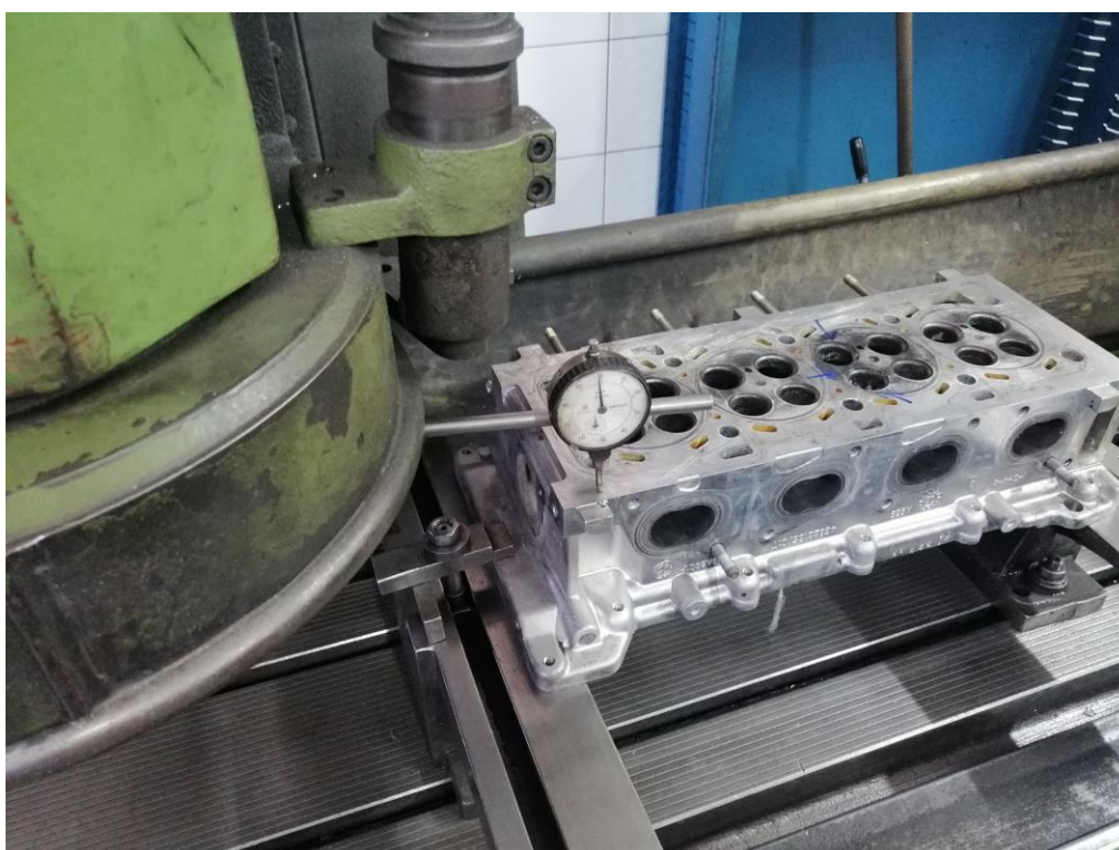
Slika 23 Određivanje najniže točke glave uz pomoć komparatora.
