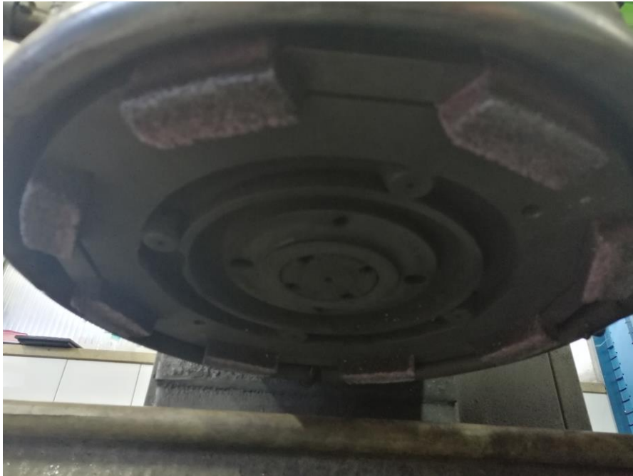
Slika 24 Primjer glave za obradu čeličnih blokova
