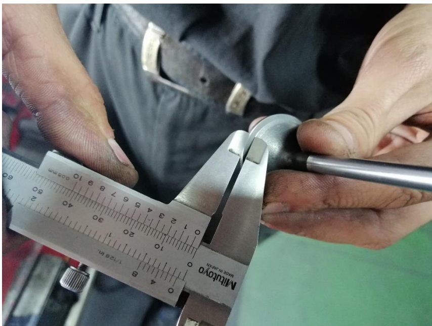
Slika 38 Kontrolna provjera širine ležišta.
