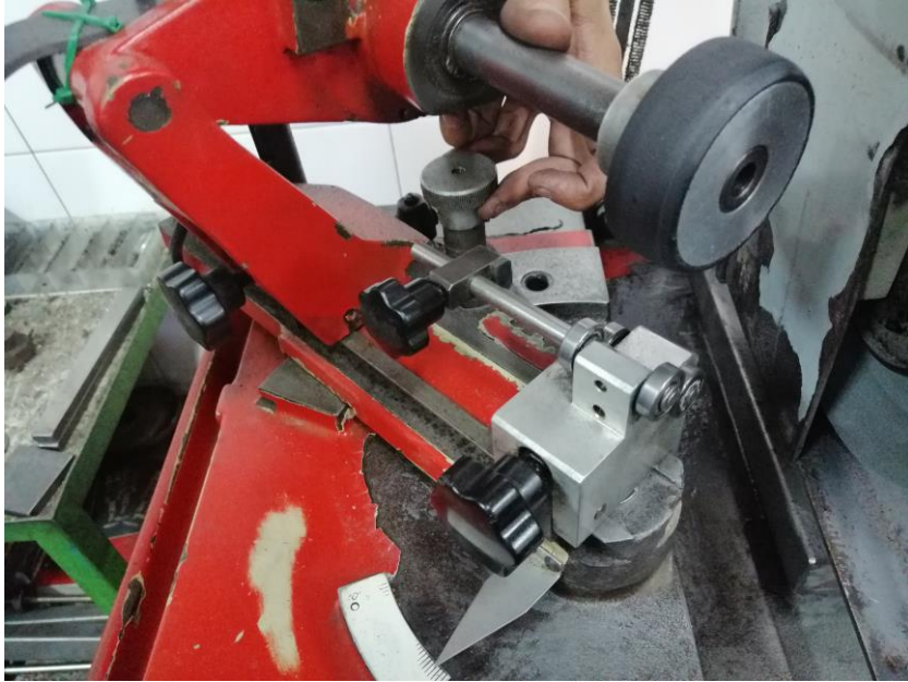
Slika 35 Podešavanje kuta obrade ventila s obzirom na preporuke proizvođača.
