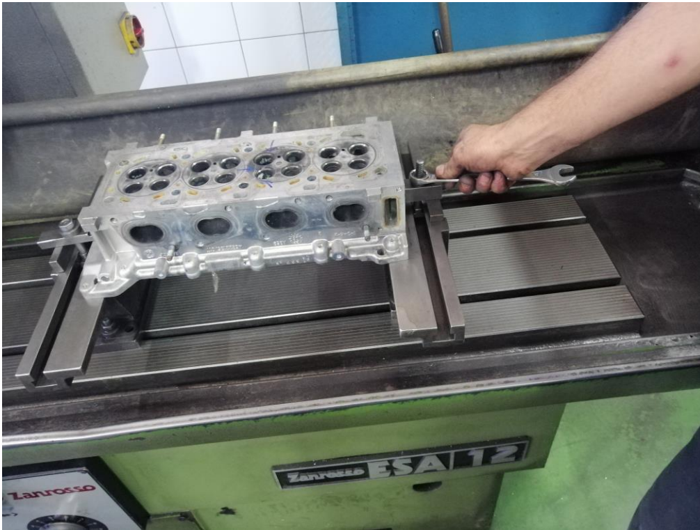
Slika 22 Pričvrščivanje držača na radni stol
