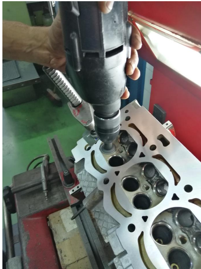
Slika 30 Rotacija obrađenog ventila u sjedištu kako bi se provjerila njihova zračnost i širina dosjeda
