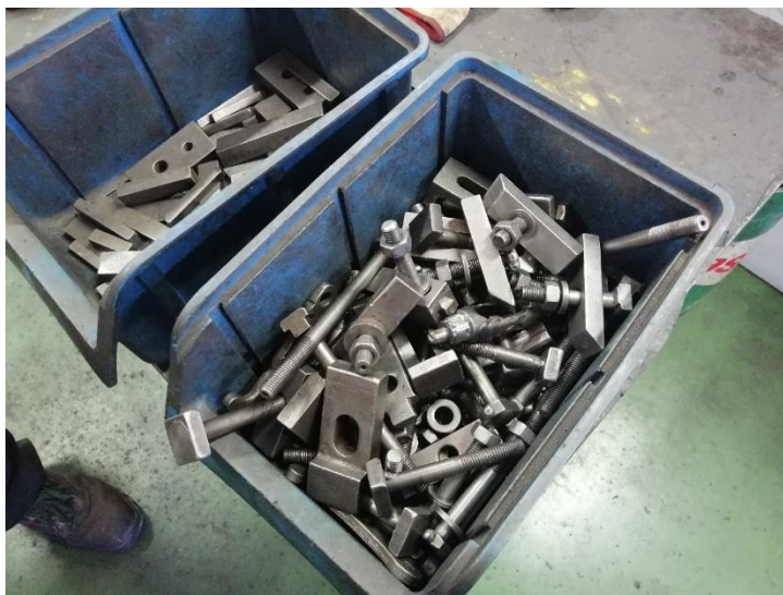
Slika 21 Razni dijelovi uz pomoću kojih je moguće pričvrstiti glavu na stol.
