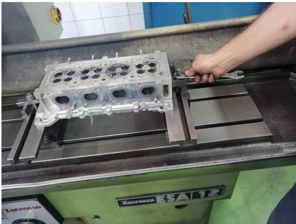
Slika 22 Pričvršćivanje držača na radni stol
