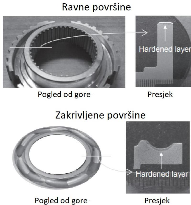
**Slika 14.** Površine kružnog oblika [22]
