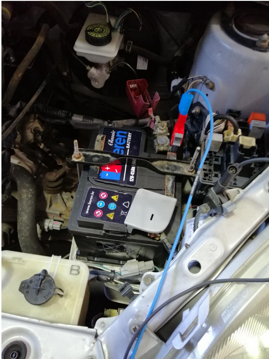
Slika 28 Spojen kanal A PicoScopea na akumulator Izvor: Autorska slika
