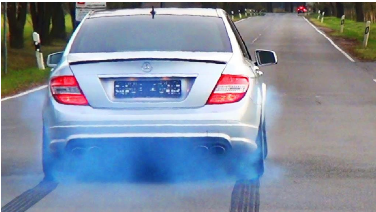
Slika 2 Primjer plavog dima koji je indikator mješanja ulja u komori Izvor: https://static.carfromjapan.com/wp-content/uploads/2018/08/blue-smoke-from-car-exhaust-1024x578.png [Pristupljeno: 29.6.2019.]
