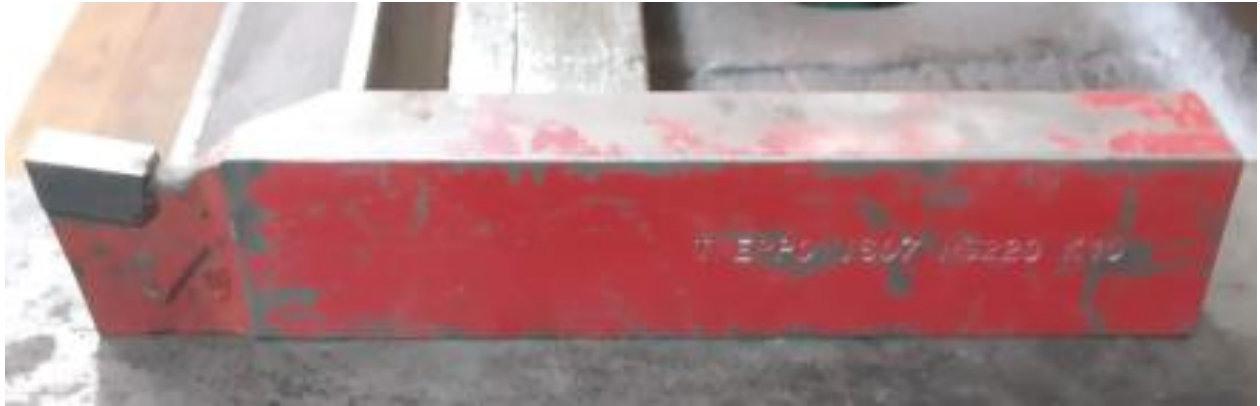
Slika 11. Tokarski nož "Vidia" sa zalemljenom pločicom
