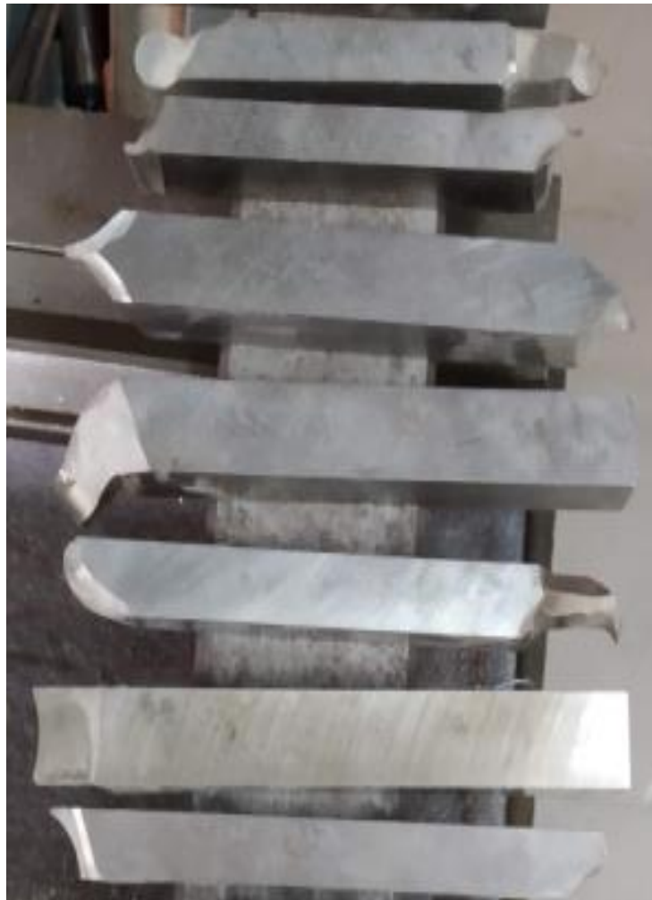
Slika 12. Jednodijelni tokarski noževi "Stirija"
