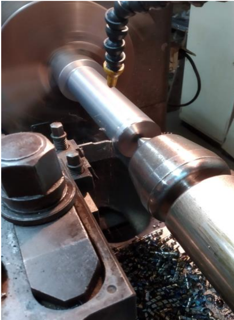
Slika 4. Uzdužno vanjsko tokarenje
