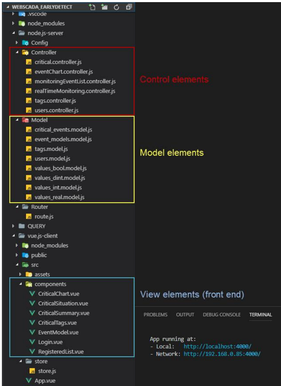
Slika 9: MCV arhitektura – struktura direktorija
