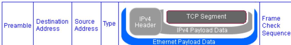
Slika 3. Ethernet okvir obuhvaćajući sloj 3 i iznad sloja 3.
