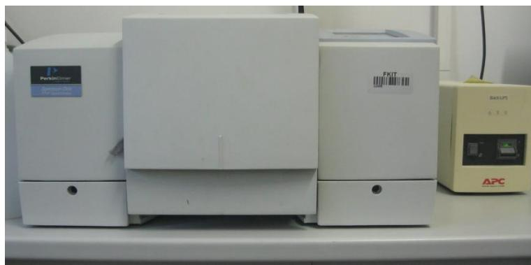
**Slika 14.** FTIR spektrofotometar, Perkin Elmer
