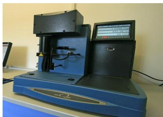
**Slika 16.** Termogravimetar TG A Q500
