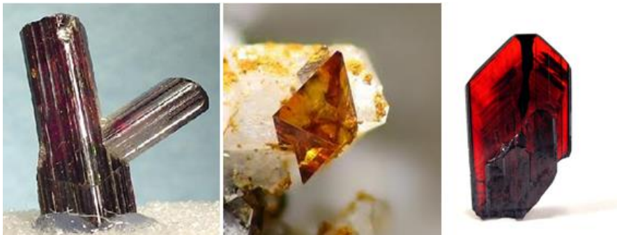
Slika 4. Polimorfne modifikacije \text{TiO}_2 : rutil, anatas, brukit [18]
