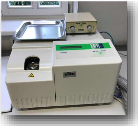
**Slika 15.** Diferencijalni pretzražni kalorimetar, DSC 822<sup>e</sup>, Mettler Toledo
