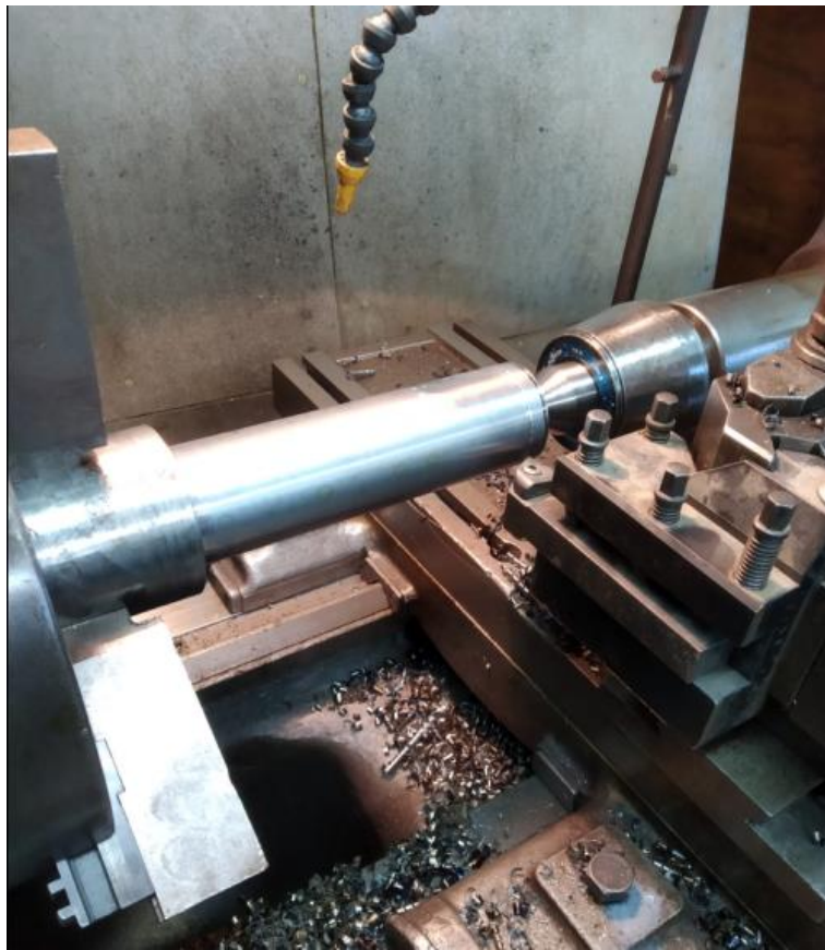
Slika 14. Prikaz komada fiksiranog u dvije točke
