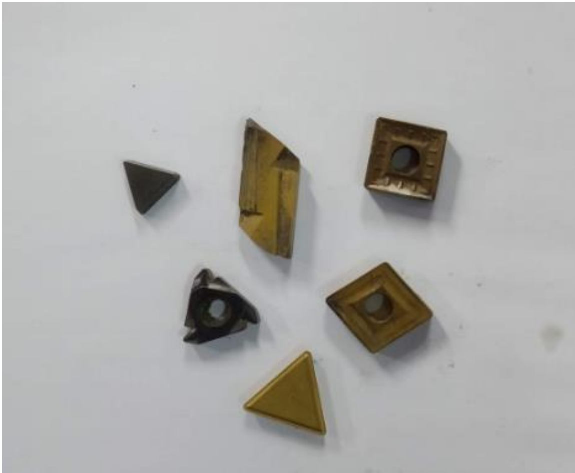
Slika 10. Vrste i oblici pločica za tokarenje
