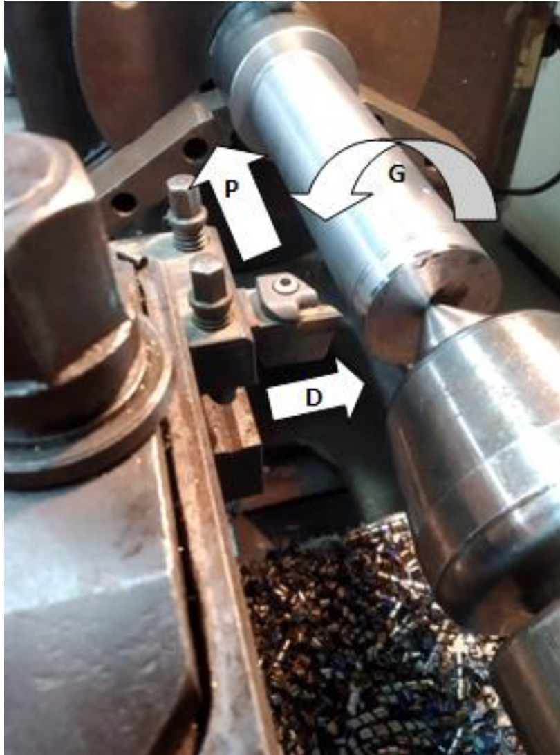
Slika 8. Prikaz gibanja na tokarskom stoju
