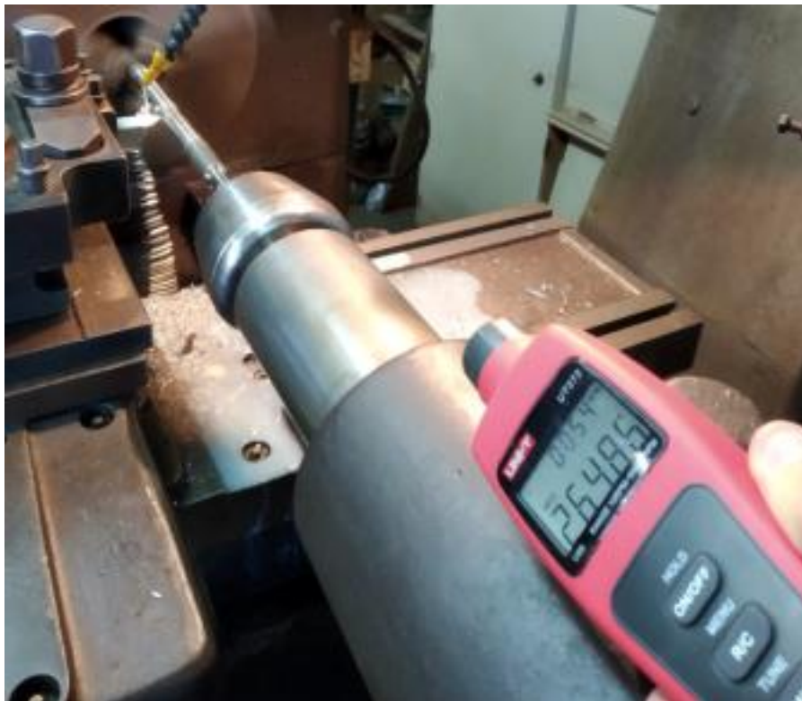
Slika 33. Tahometar mjeri brzinu vrtnje na steznoj glavi
