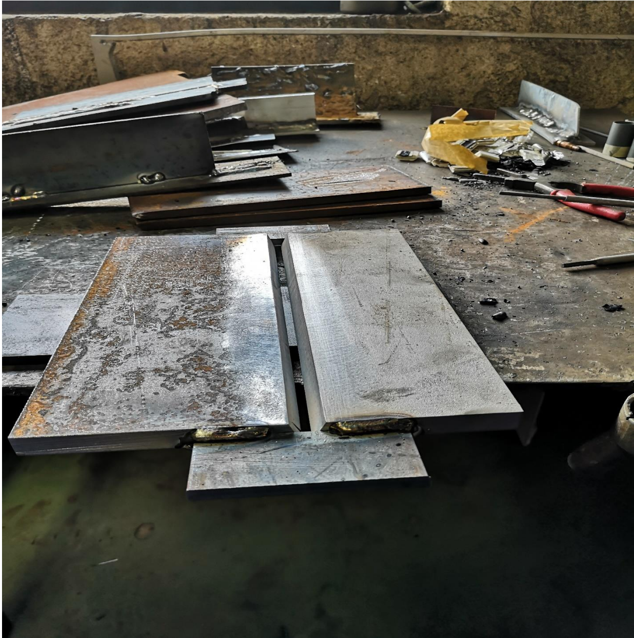
Slika 6 Pripremljeni "V" spoj
