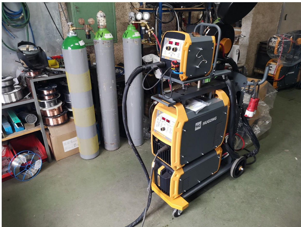
Slika 2 Aparat za MAG zavarivanje
