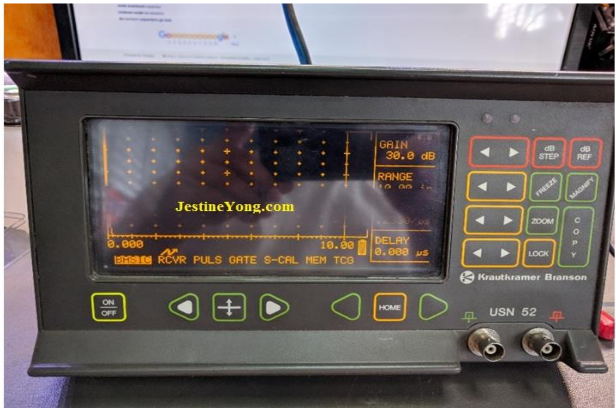
Slika 18 Uređaj za ultrazvuk - Krautkramer USN 52
