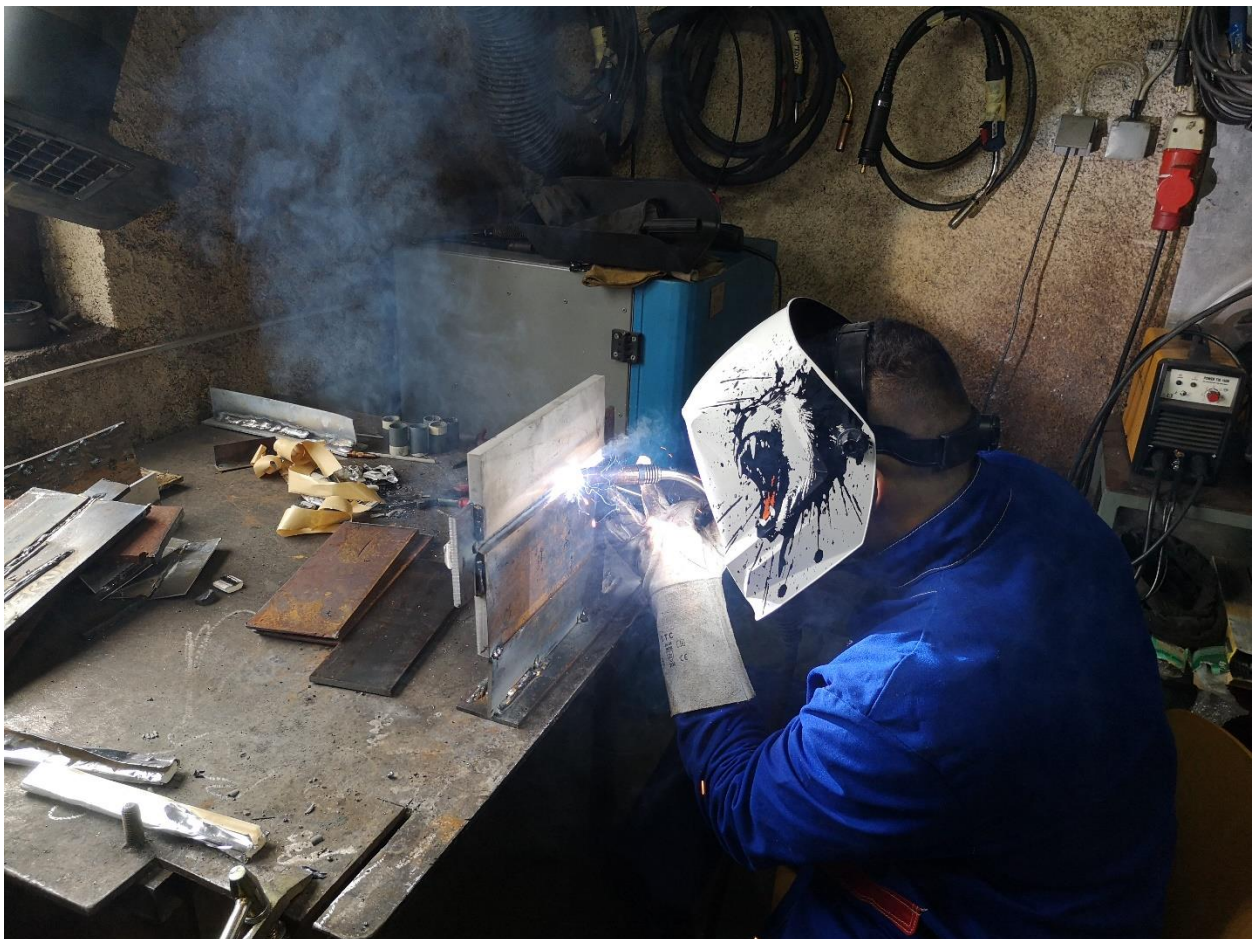
Slika 11 Autor osobno zavaruje spoj u zidnoj poziciji
