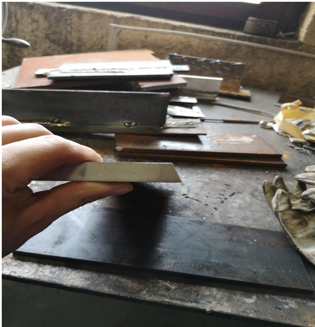
Slika 5 Obradjeni kut polovice spoja- 22.5^\circ
