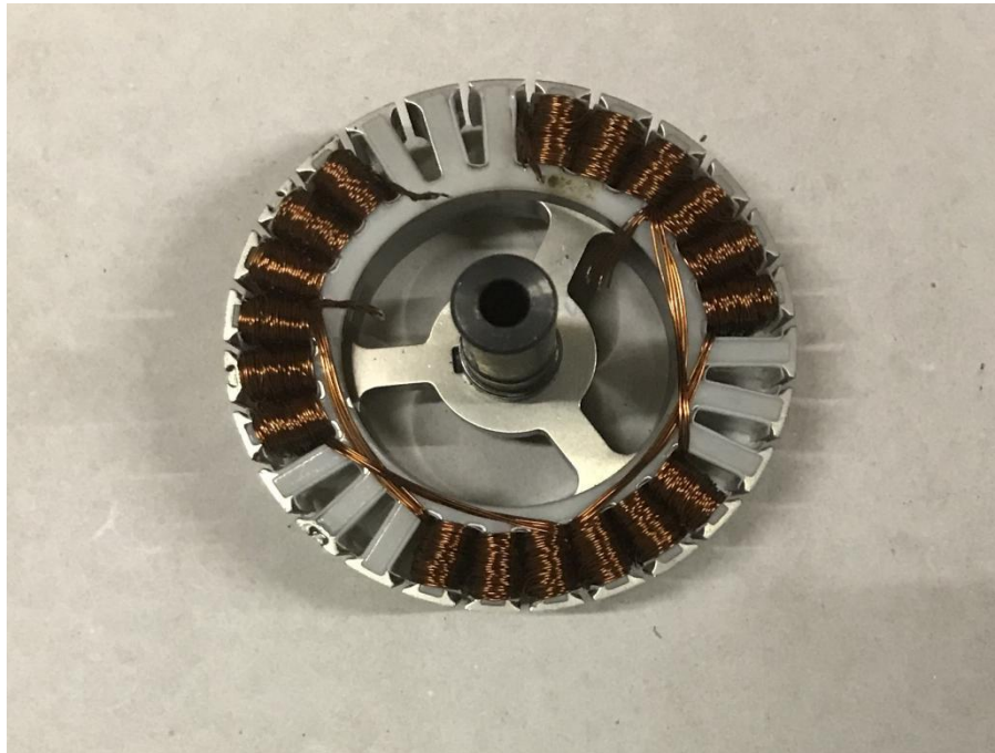
Slika 27: Stator s dvije namotane zavojnice
