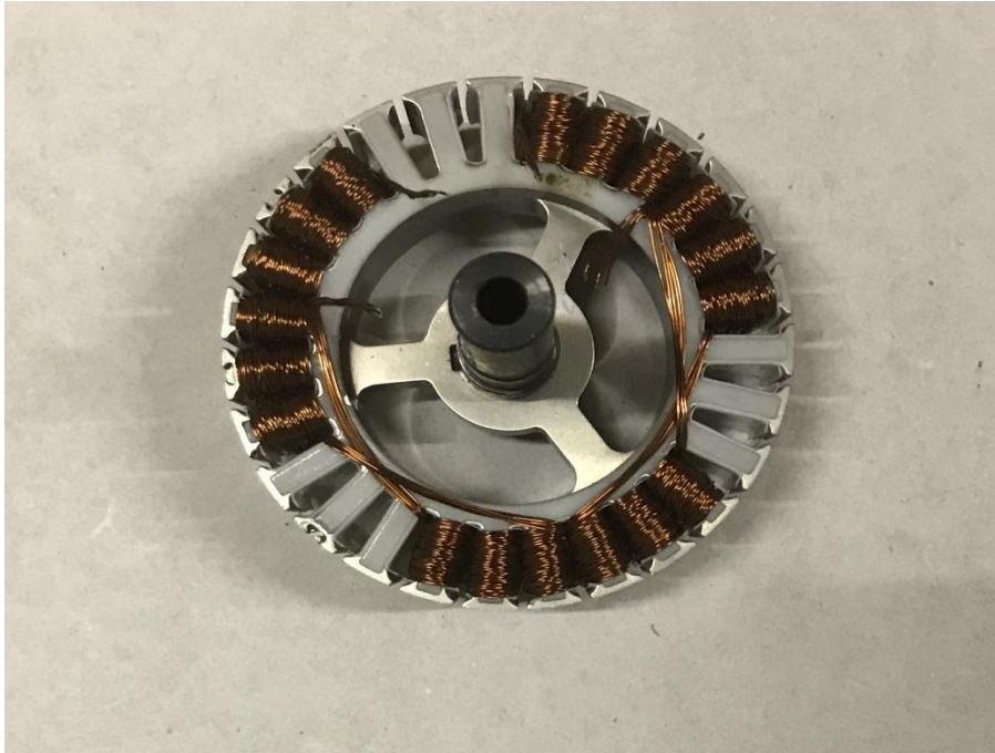
Slika 27: Stator s dvije namotane zavojnice
