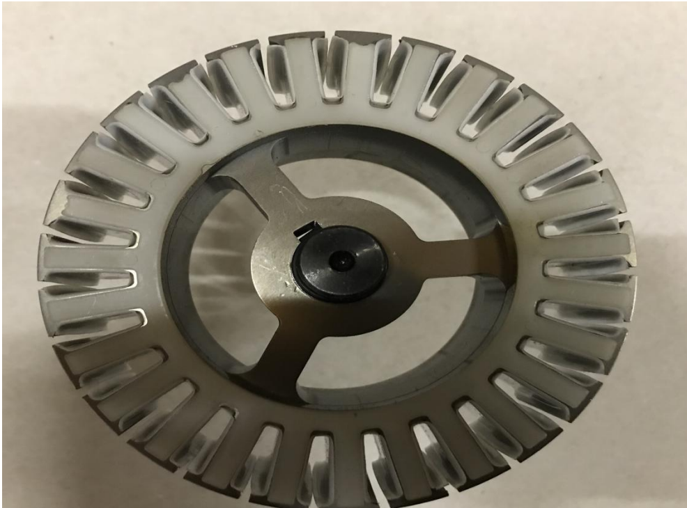
Slika 22: Stator sa postavljenim zaštitama
