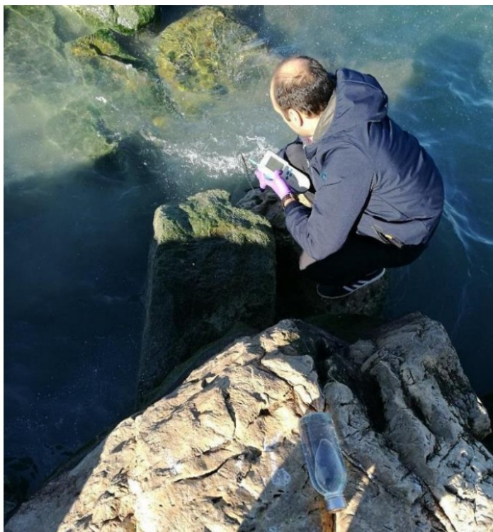
Slika 2. Uzimanje uzorka i mjerenje hidrografskih uvjeta sondom kod ispusta otpadnih voda tvornice za preradu ribe
