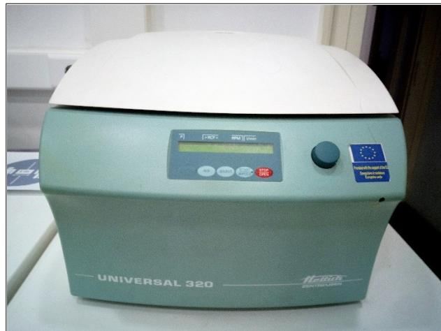
**Slika 7.** Centrifuga korištena za odjeljivanje meiofaune iz sedimenta.
