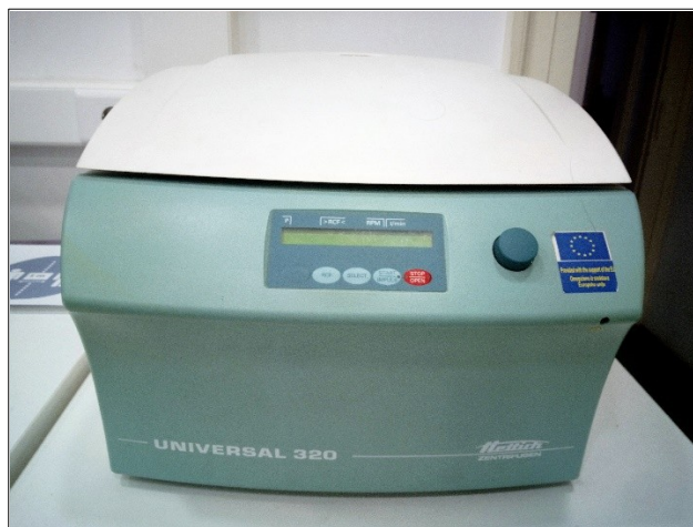
Slika 7. Centrifuga korištena za odjeljivanje meiofaune iz sedimenta.
