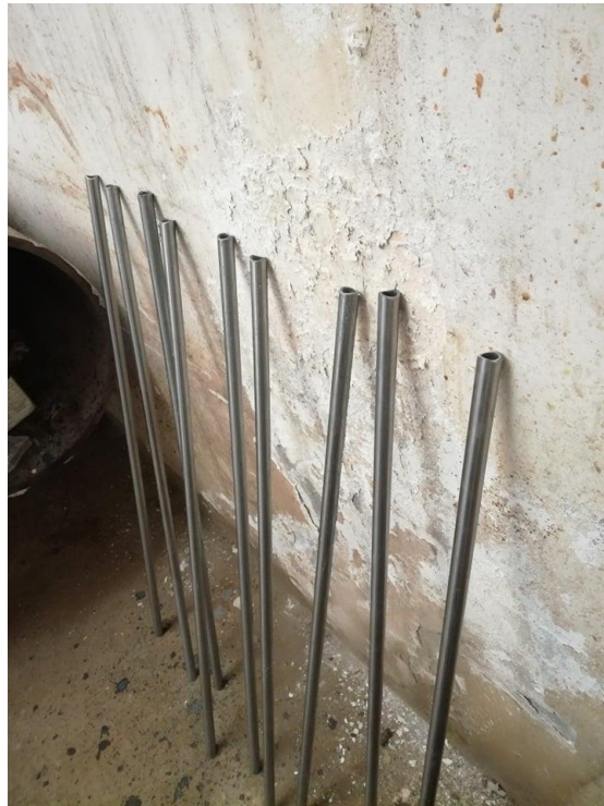
Slika 15. Cijevi nakon faze rezanja i savijanja, 1.
