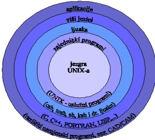
Slika 8. Prikaz strukture UNIX-a (Žagar, 1995)
