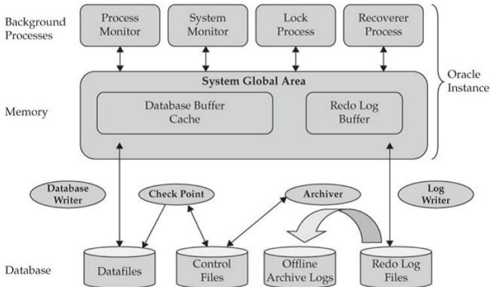
Slika 11. Prikaz arhitekture i procesa unutar Oracle baze podataka(*Oracle Database Internal Architecture, bez dat.*)
