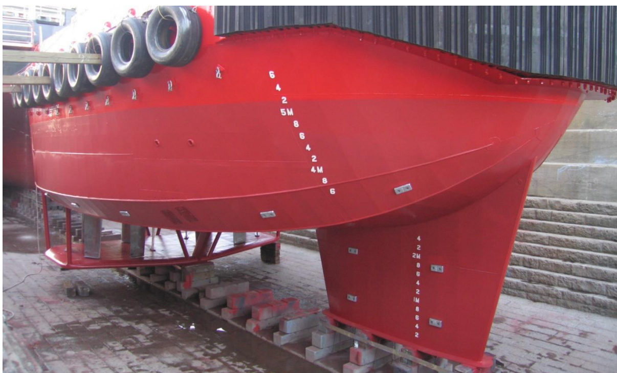
Slika 18 Primjer sustava pasivne katodne zaštite na brodu. Vidljive su brojeve žrtvene anode na trupu broda. Izvor: https://korrosionsgruppen.se/wp-content/uploads/2019/11/Hull-Anodes.jpg
