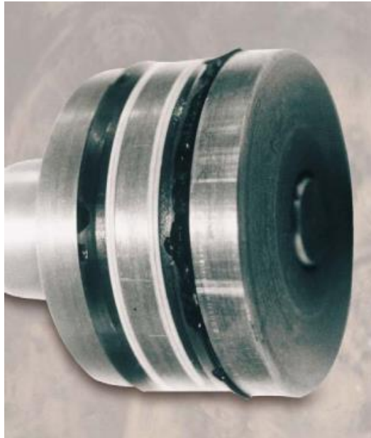
Slika 21 Oštećenje klipa cilindra
