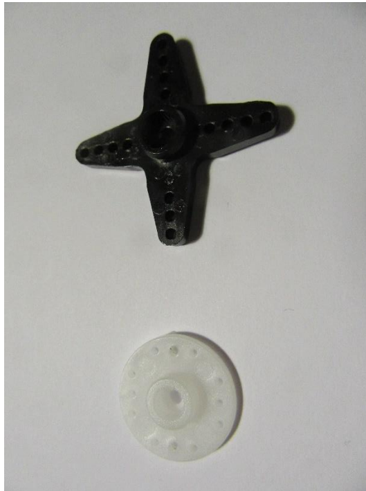
Slika 32: Plastični dodatci za povezivanje servo motora sa robotskom rukom Izvor: obrada autora
