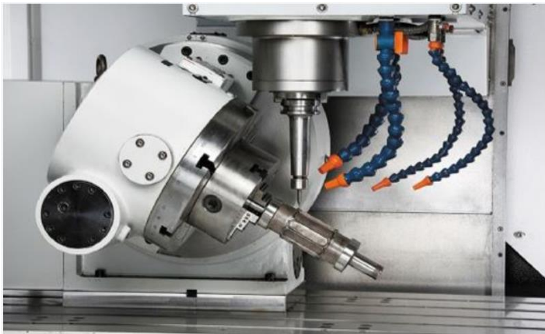
Slika 1 Prikaz obrade na pet osnoj glodalici
