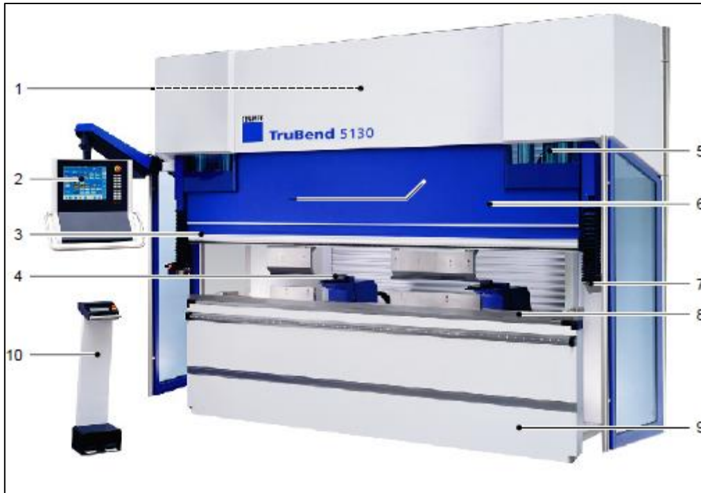
Slika 16. Komponente stroja TruBend 5130.
