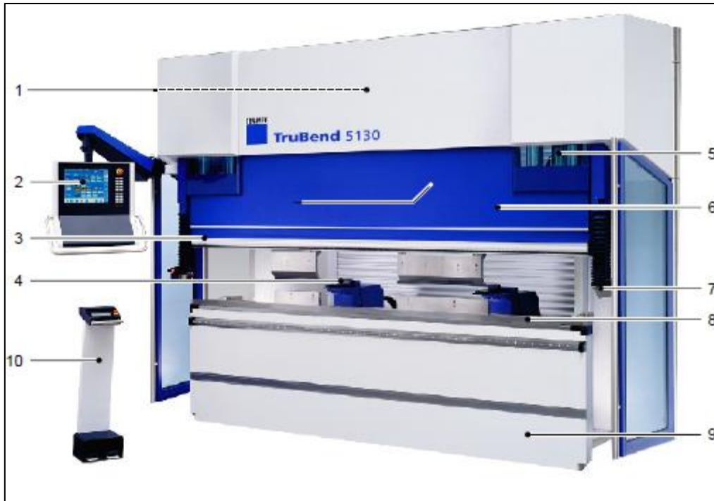
Slika 16. Komponente stroja TruBend 5130.
