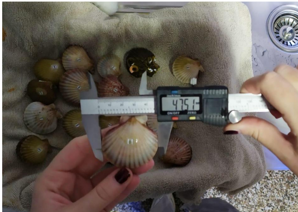
Slika 9. Prikaz mjerenja školjkaša pomoću digitalne pomične mjerke.
