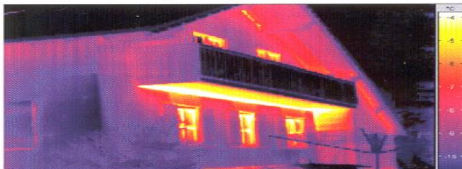
Slika 8. Termografski snimak kuće
