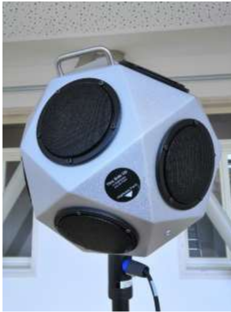
Slika 43. glava uređaja za generiranje izvora zvuka
