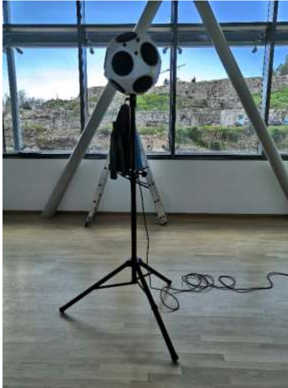
Slika 42. Uređaj za generiranje izvora zvuka (šuma)
