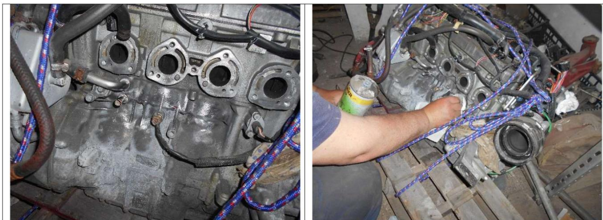
Slika 47. Nakon što se površina osušila pristupilo se nanošenju crvenog penetranta (Izvor: obrada autorice)
