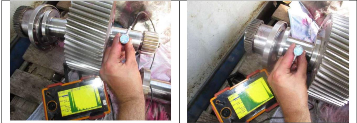
Slika 42. Ispitivanje ležajnih rukavaca kod pogonskog zupčanika
