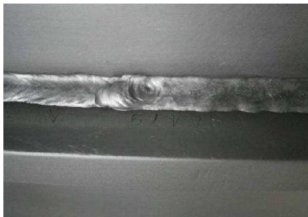
Slika 5. Šupljina ili poroznost u završnom krateru
