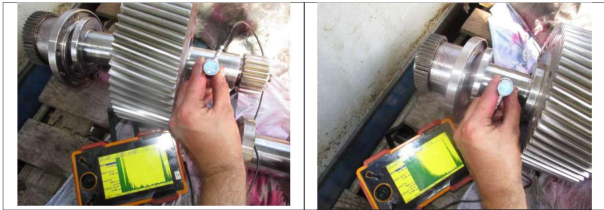
Slika 42. Ispitivanje ležajnih rukavaca kod pogonskog zupčanika
