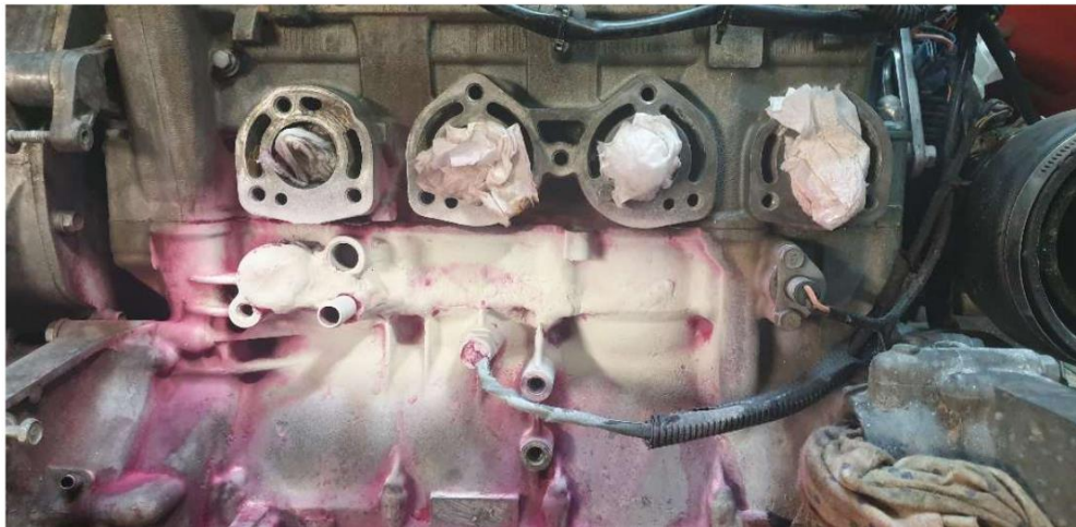
Slika 54. Nakon zavarivanja ponovno se pristupilo penetranskom ispitivanju (Izvor: obrada autorice)
