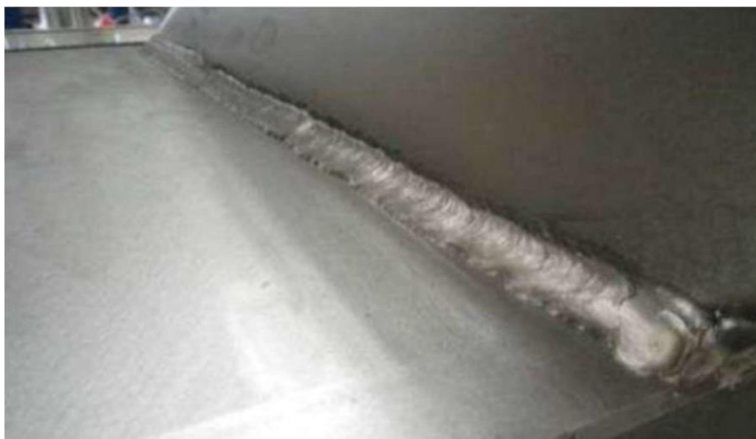
Slika 14. Primjer ugorina po cijeloj dužini zavora
