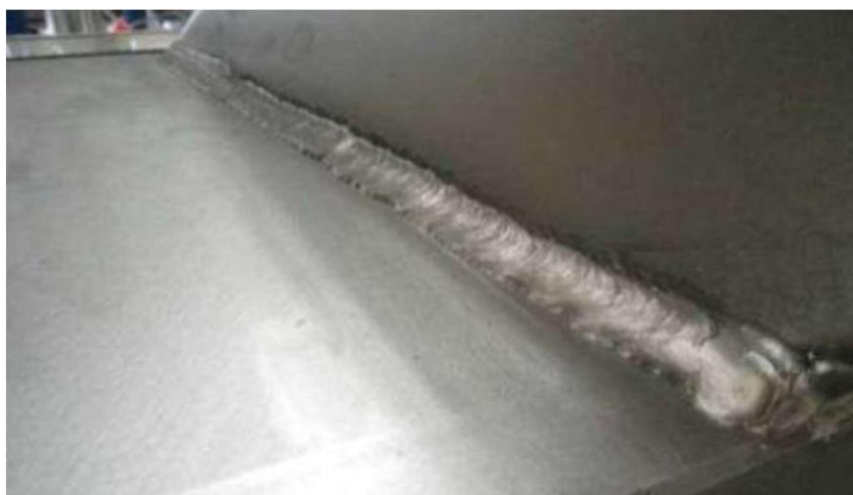
Slika 14. Primjer ugorina po cijeloj dužini zavora
