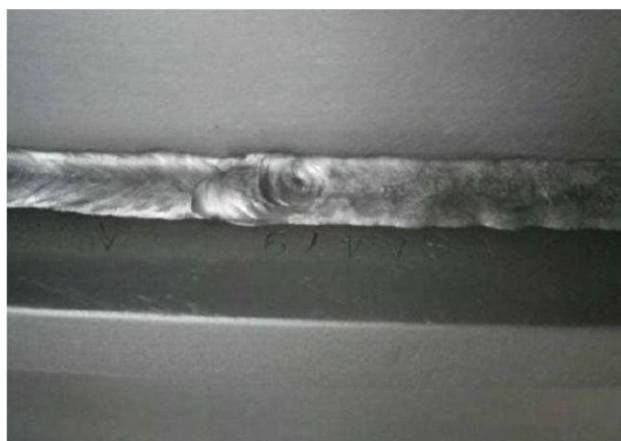
Slika 5. Šupljina ili poroznost u završnom krateru
