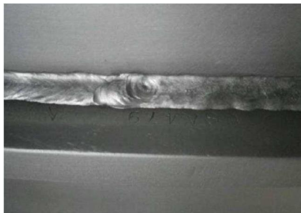
Slika 5. Šupljina ili poroznost u završnom krateru
