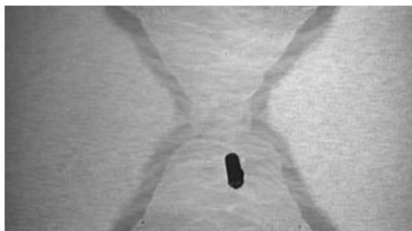
Slika 7. Uključina stranog metala
