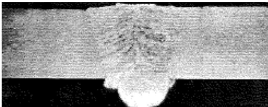
Slika 20. Pretjerani ili preveliki provar (Izvor: www.twi-global.com )
