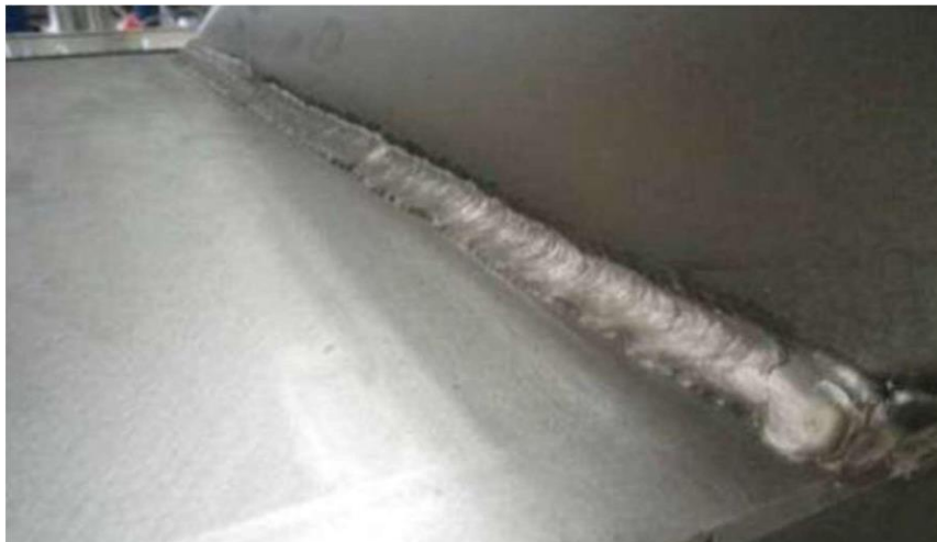
Slika 14. Primjer ugorina po cijeloj dužini zavara
