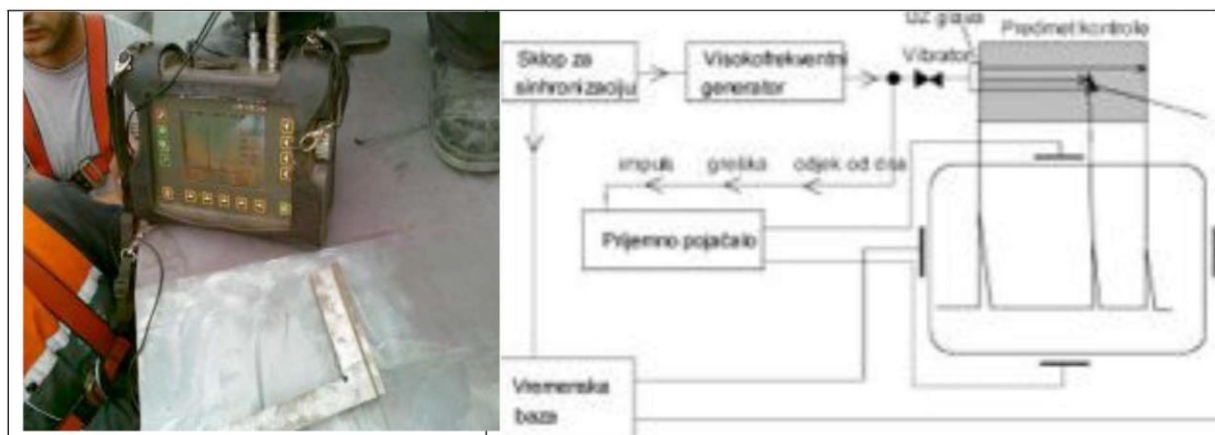
Slika 58. Primjer ultrazvučnog ispitivanja zavara 2/2 (Izvor: obrada autorice)
