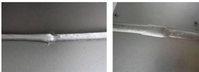
Slika 24. Nepravilno izveden nastavak zavar - (Izvor: www.twi-global.com )
