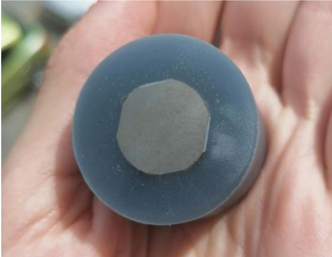
Slika 18 – Površina nagrizanog uzorka bez mikroskopa
