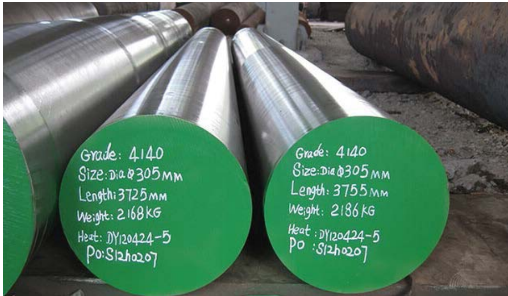
Slika 2. Šipke legure N.1.7227, AISI 4140
