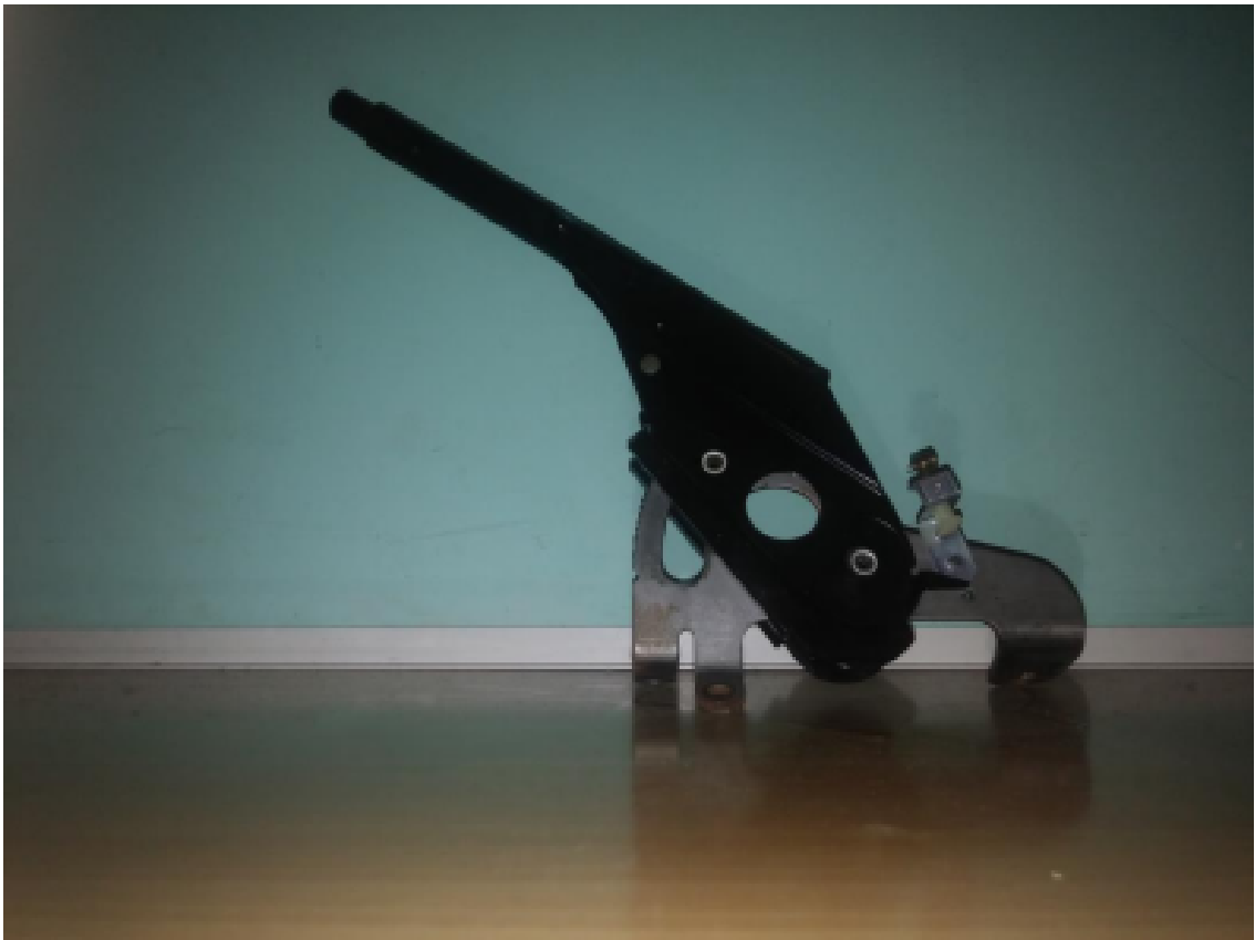
Slika 13. Prikaz ručne poluge u zategnutom stanju
