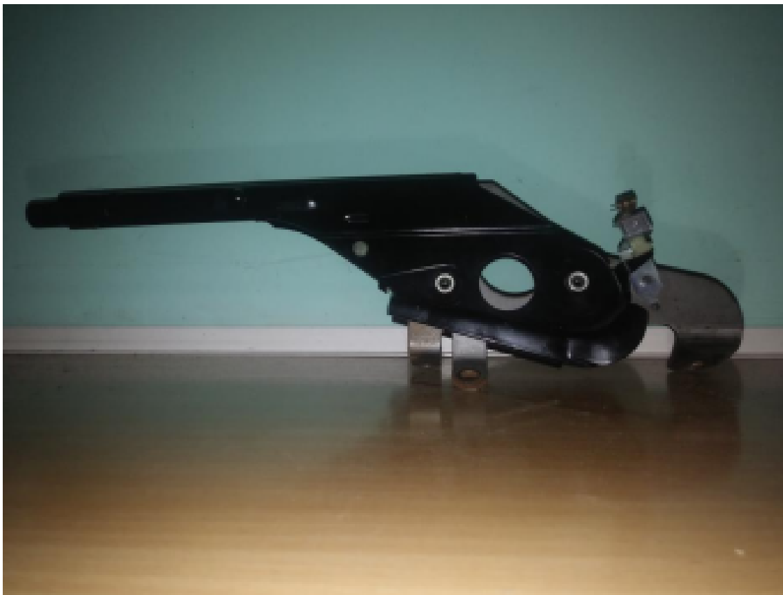
Slika 12. Prikaz ručne poluge u opuštrenom stanju
