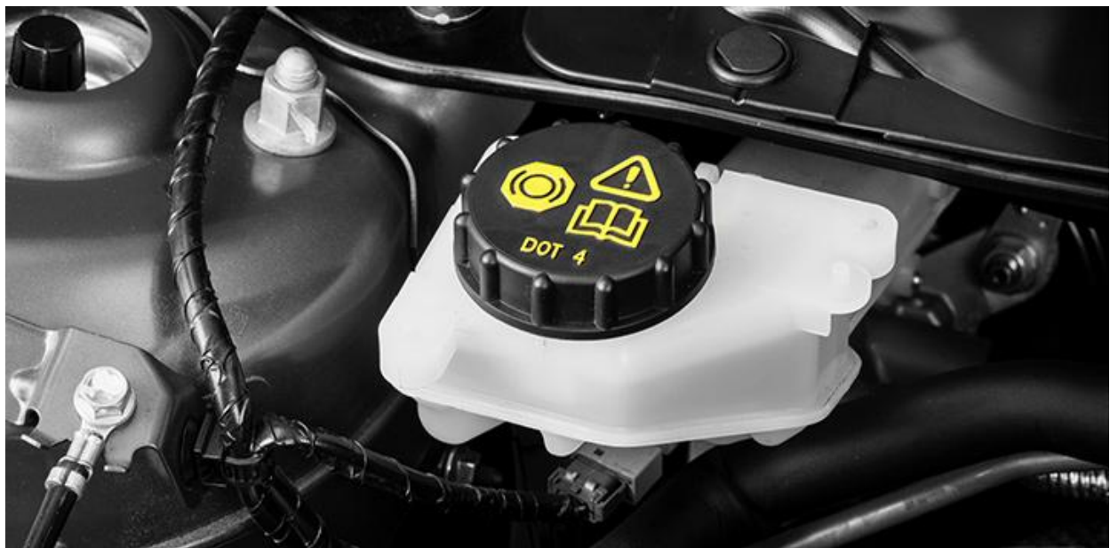
Slika 14. Spremnik tekućine za kočenje sa označenim DOT-om
