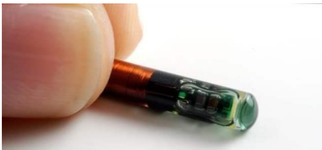
Slika 4 Prikaz ljudskog RFID čipa
