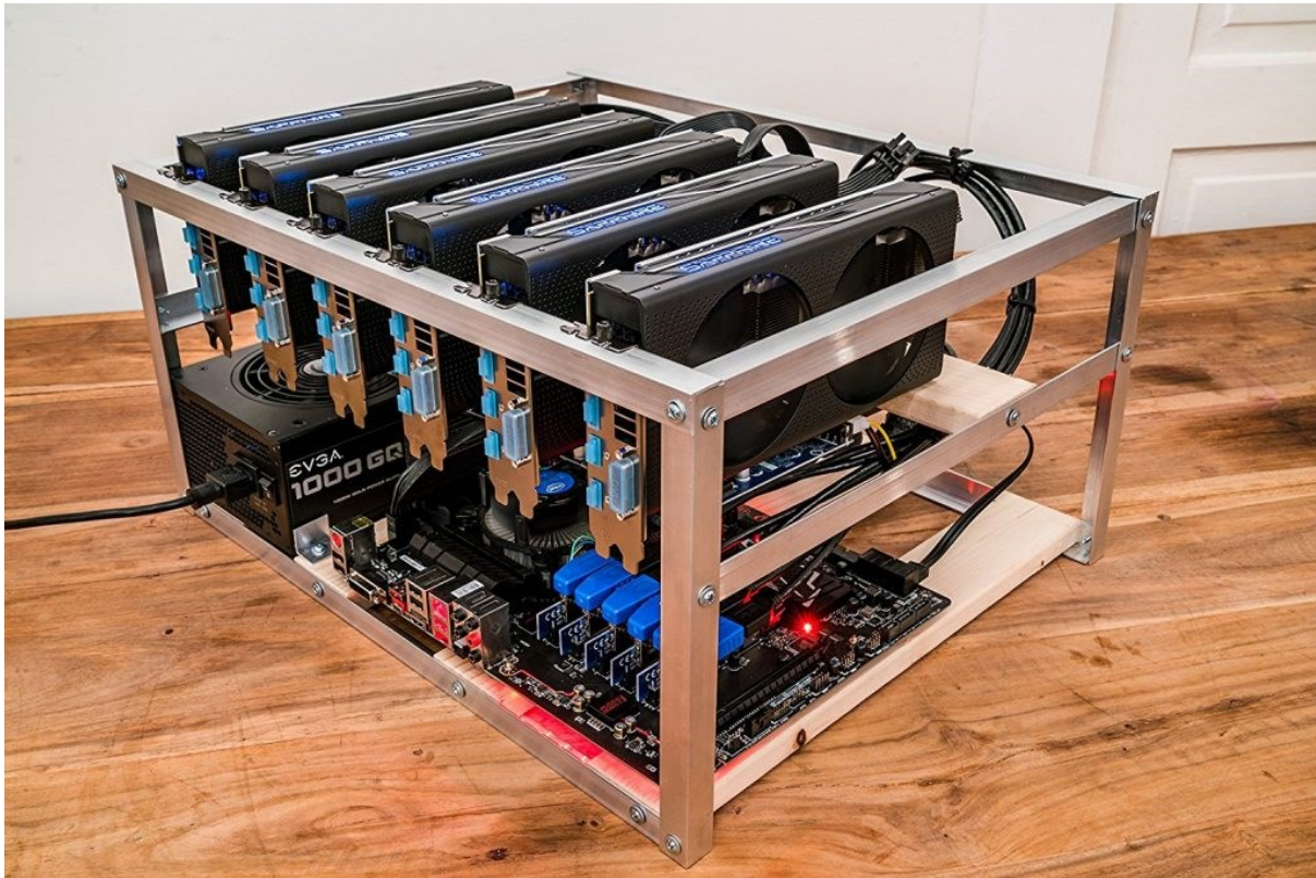
Slika 15: Rudarska platforma ( eng. Mining rig )
