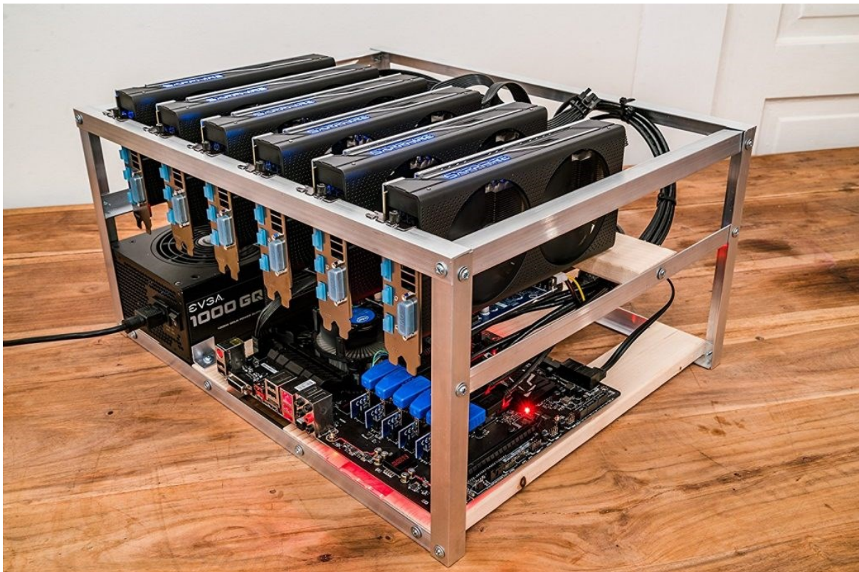
Slika 15: Rudarska platforma ( eng. Mining rig )
