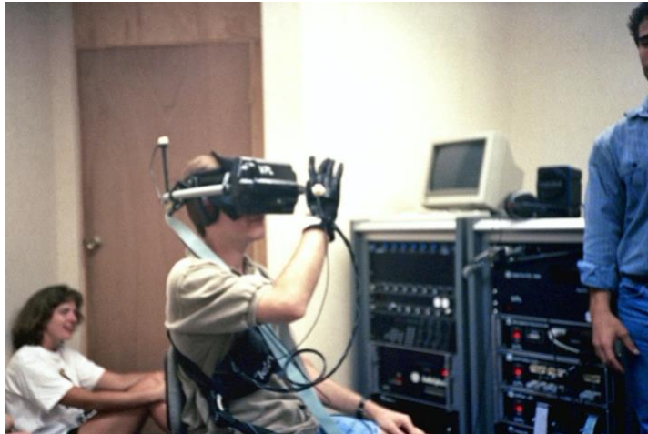
Slika 9. J.Lanierovi „EyePhone“ i „DataGlove“ u primjeni 1984. godine ( https://therealmccrea.files.wordpress.com/2014/06/10-1.jpg )
